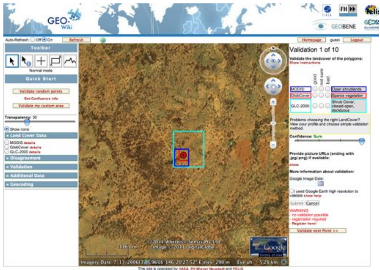
Abbildung 10: Geo-Wiki - Auf der linken Seite kann ausgewählt werden, ob ein zufälliger Punkt oder ein bestimmter Punkt validiert werden soll. In der Mitte des Bildes sind die zu validierenden Flächen eingezeichnet, welche aus drei verschiedenen Satellitensystemen eingespeist werden. Auf der rechten Seite kann angegeben werden, ob die vorläufige Validierung korrekt ist und wenn nicht, diese verbessert werden.
