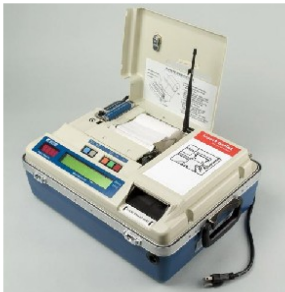
Abbildung 7: Optischer Scanner für Lochkarten. Quelle http://americanhistory.si.edu/vote
