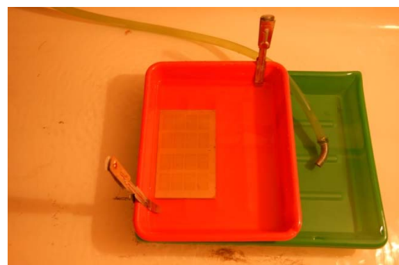
Abbildung 68: Ätzen einer Leiterplatte
